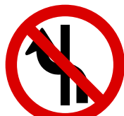
R-8b Proibido mudar de faixa ou pista de trânsito da direita para esquerda
