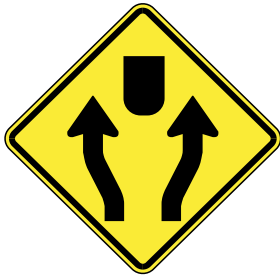
A-21e Alargamento de pista à direita
